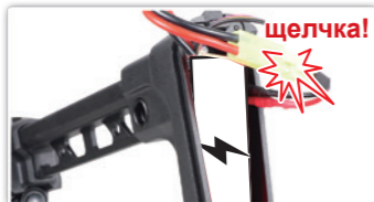
Подсоедините аккумулятор до щелчка.
